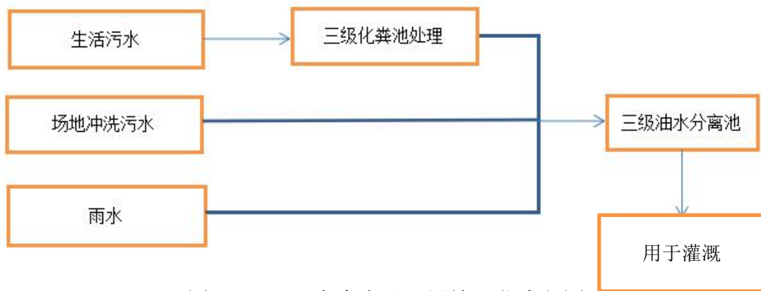
图 4-1 现有废水处理设施工艺流程图
