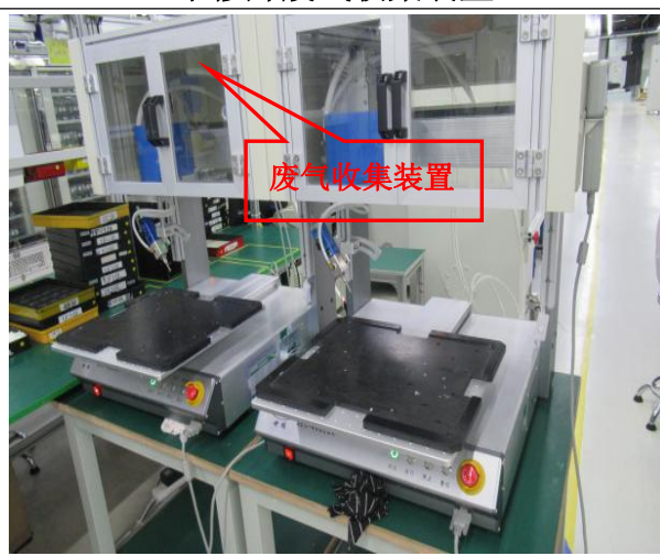
自动点胶工位及废气收集装置
