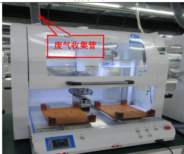
自动焊锡废气收集装置
