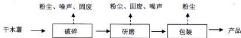
图 1 生产工艺流程及产污环节示意图
