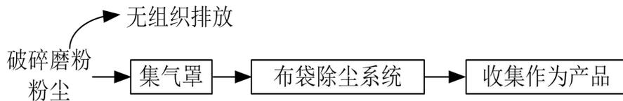
图 3-1 废气处理设施流程图
