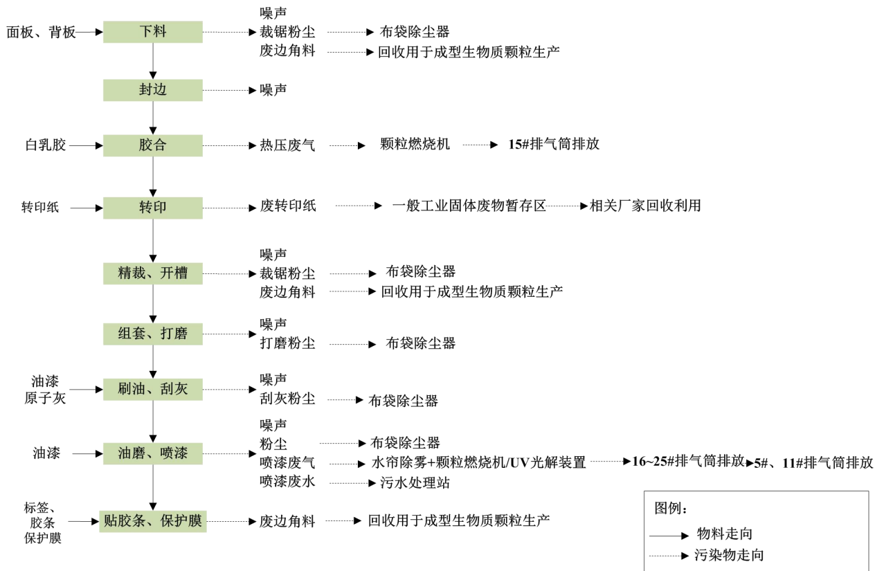
图 2.2.1-7 木质门套、木质防火门套（含门框）生产工艺流程及产污节点示意图
