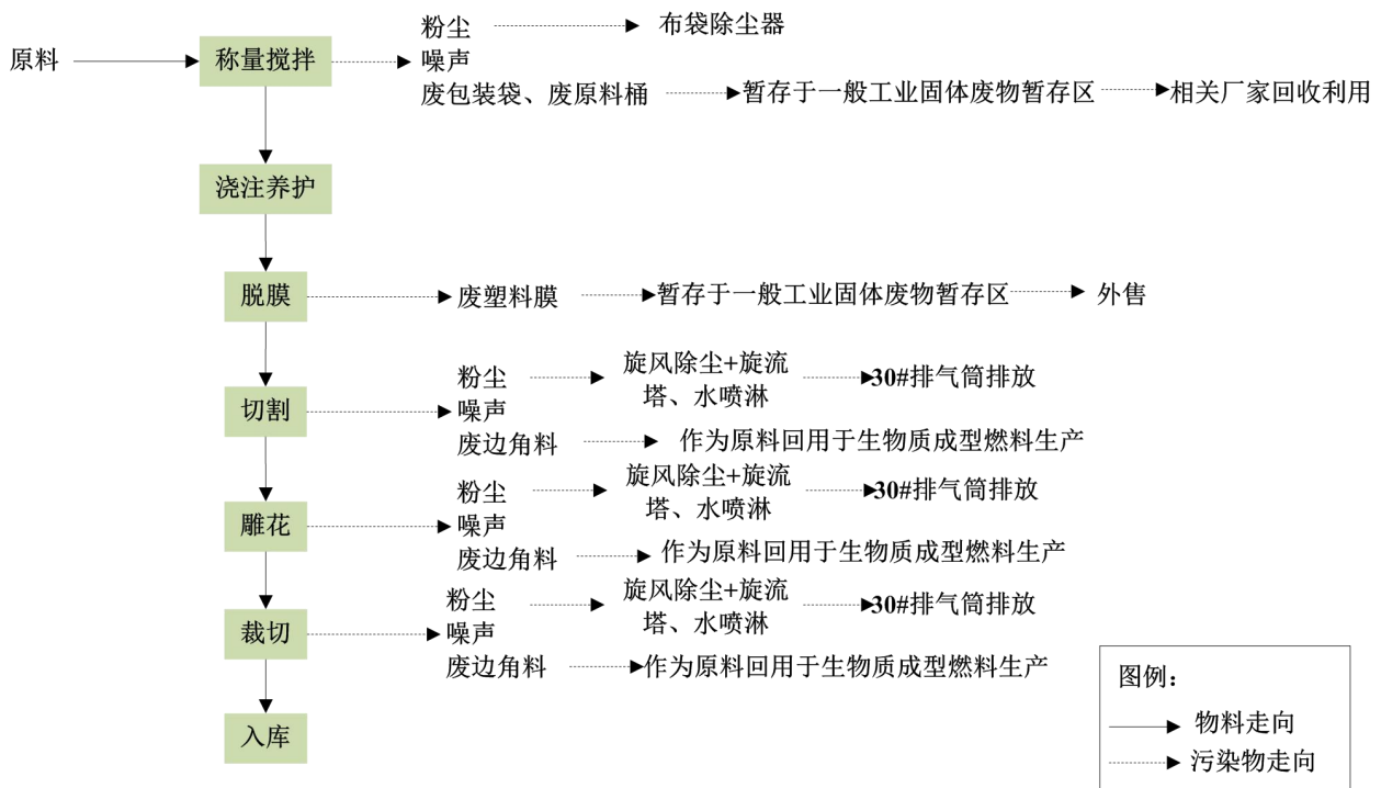
图 2.2.1-14 门芯板生产工艺流程及产污环节示意图
