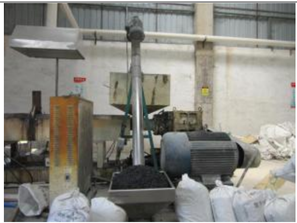
造粒生产线塑化挤出机上方的集气罩
