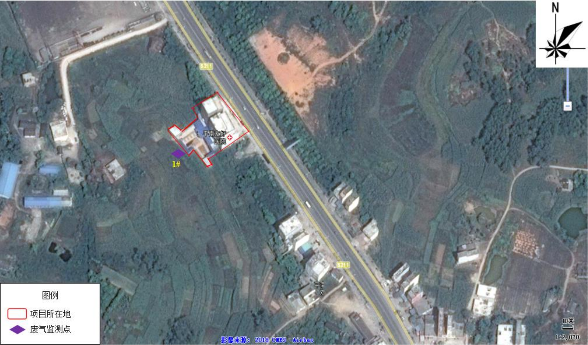
附图 3 项目无组织排放废气监测布点示意图
