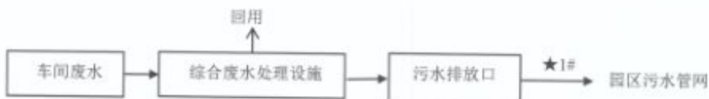
图 4 废水处理工艺及监测点位
