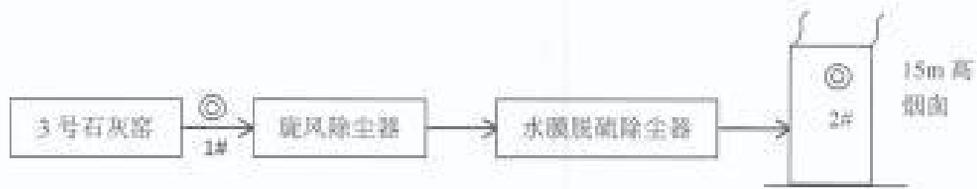
图 3 3 号石灰窑废气处理工艺及监测点位示意图
