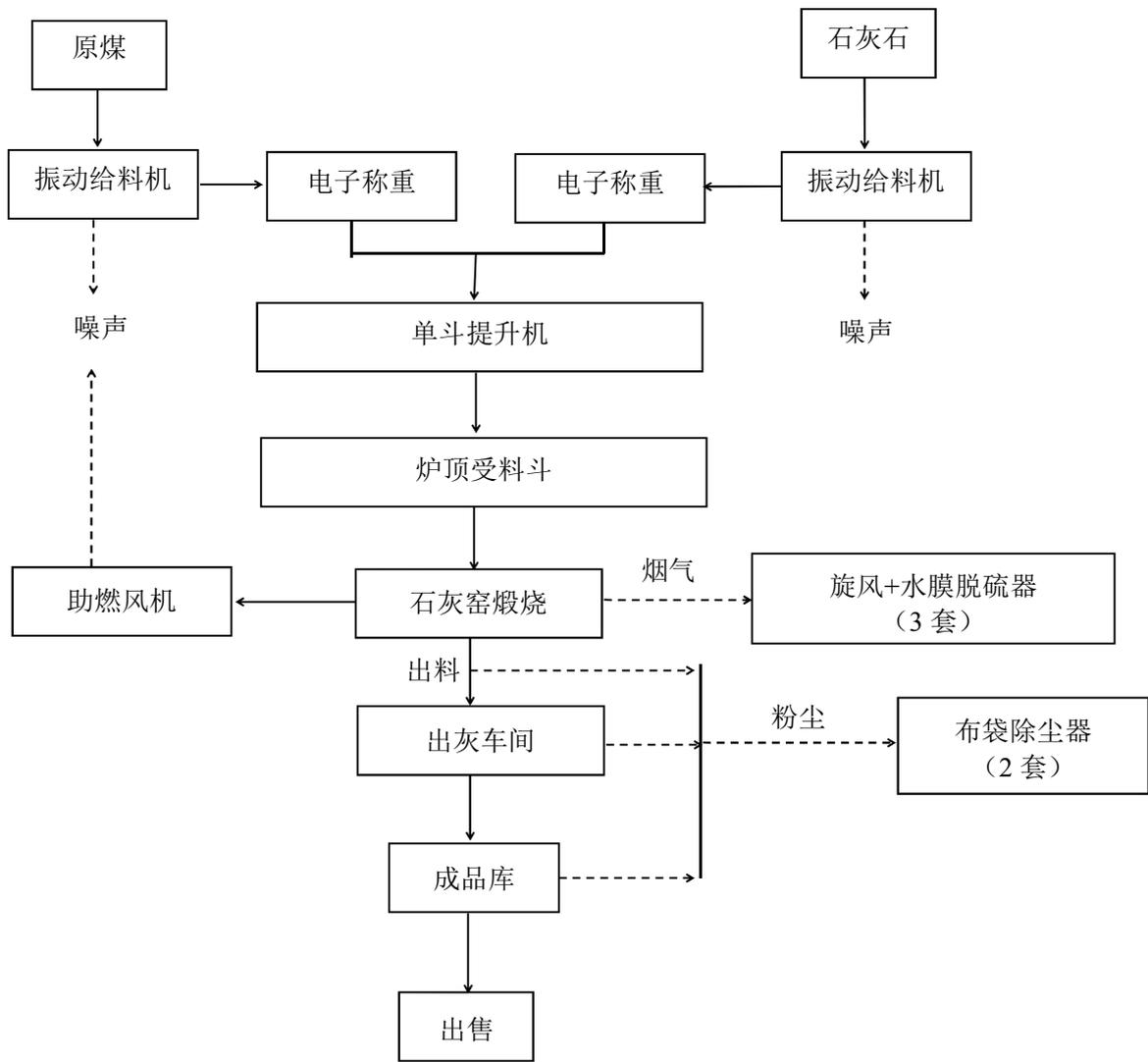
图 2-2 工艺流程及产污环节示意图
