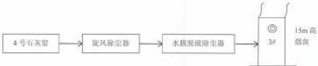
图 3 4 号石灰窑废气处理工艺及监测点位示意图
