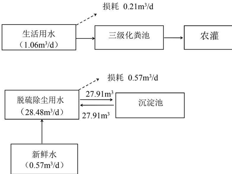
图 2-1 厂区用水平衡图 m<sup>3</sup>/d
