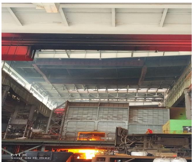
电炉密闭罩+屋顶罩
