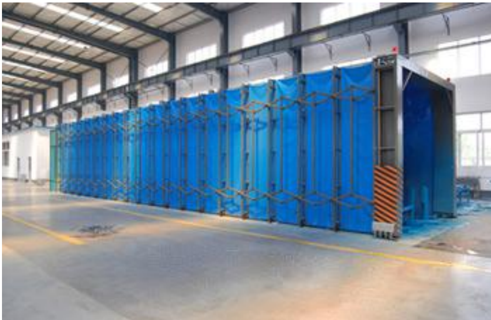
图 5.2-3 伸缩式移动喷漆房实例（展开状态）
