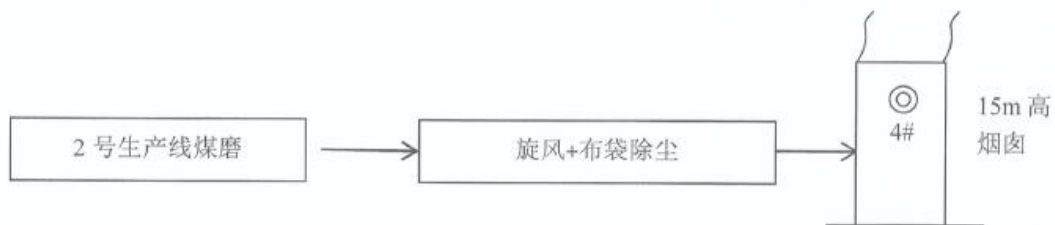
图 4 2 号生产线煤磨废气处理工艺及监测点位示意图
