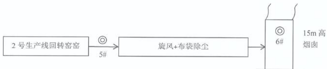
图 5 2 号生产线回转窑窑尾废气处理工艺及监测点位示意图
