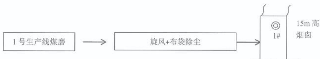
图 2 1 号生产线煤磨废气处理工艺及监测点位示意图
