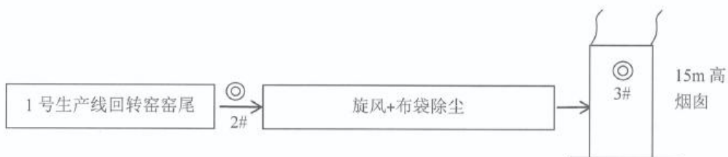
图 3 1 号生产线回转窑废气处理工艺及监测点位示意图
