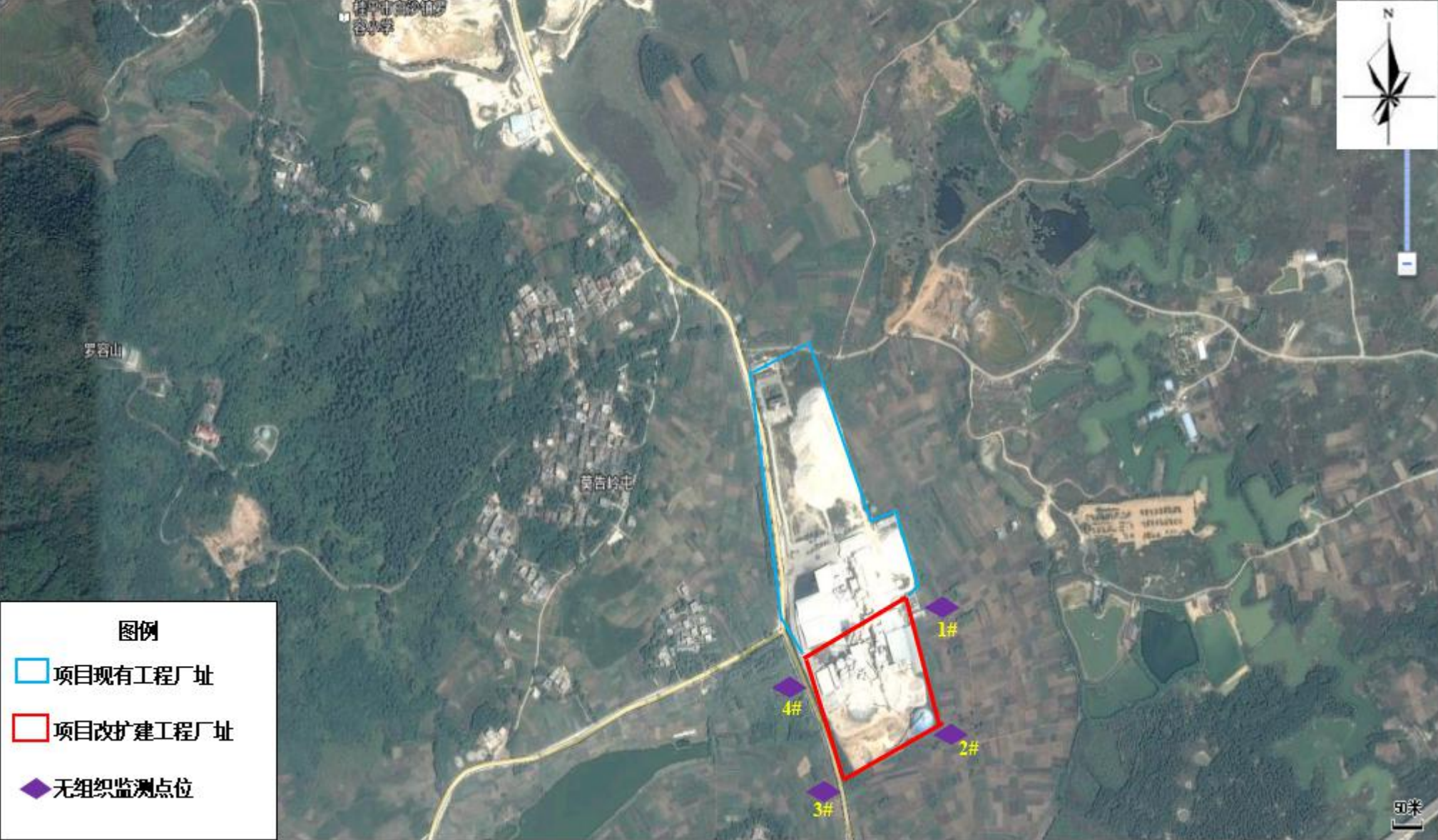
附图 3-2 项目无组织排放废气监测布点示意图
