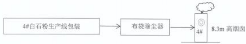
图 4 4#白石粉生产线包装处理工艺及监测点位图
