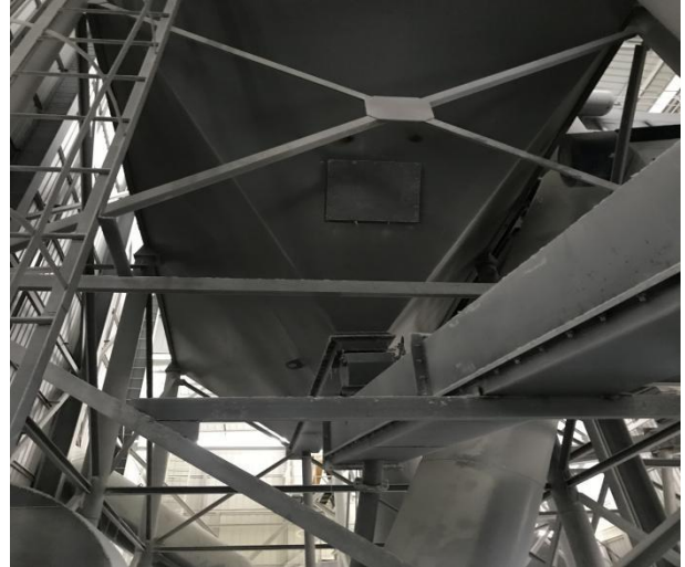
白石粉生产线立磨工艺磨尾布袋除尘器
