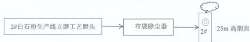
图 2 2#白石粉生产线立磨工艺磨头处理工艺及监测点位图
