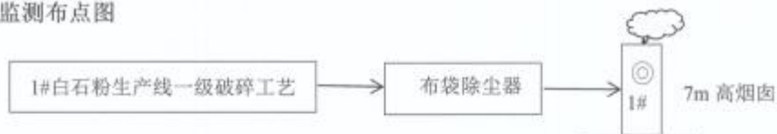
图 1 1#白石粉生产线一级破碎工艺处理工艺及监测点位图
