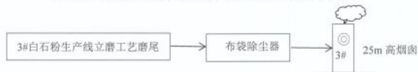
图 3 3#白石粉生产线立磨工艺磨尾处理工艺及监测点位图
