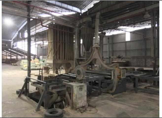
锯边砂光工序吸尘软管
