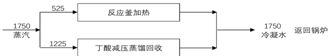
图 2.3-7 本项目蒸汽平衡图 (t/a)
