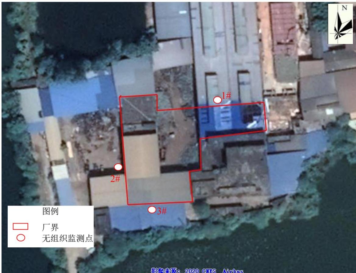
图 3-2 无组织废气监测布点图
