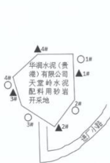
图1 无组织废气及厂界噪声监测点位图
