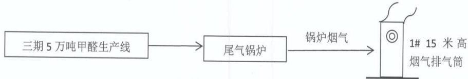
图 3 1#尾气锅炉烟气监测点位示意图
