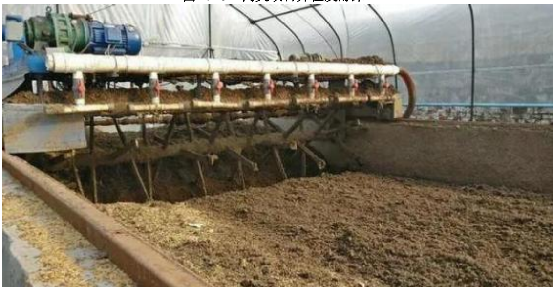
图 2.2-4 同类项目异位发酵床内翻耙机
