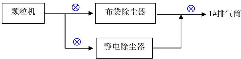
图 3-1 废气处理设施流程及监测点位图
