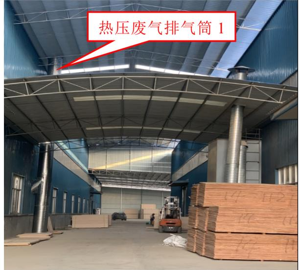
热压废气排气筒 1
