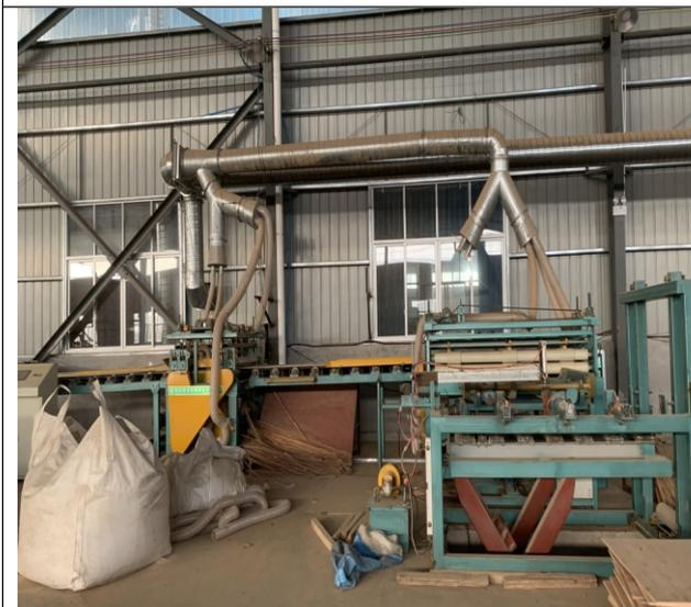
吸尘软管+废气收集管道
