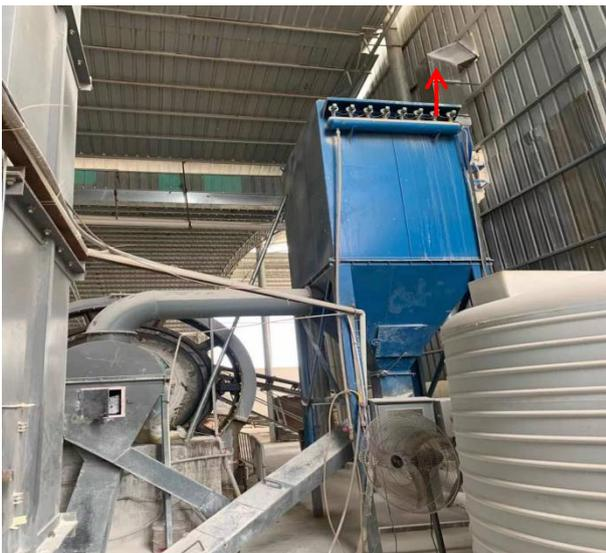
3#磨球破碎布袋除尘器排气口（监测点）
