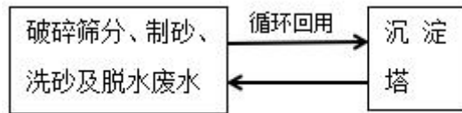
图 3-1 废水处理流程示意图
