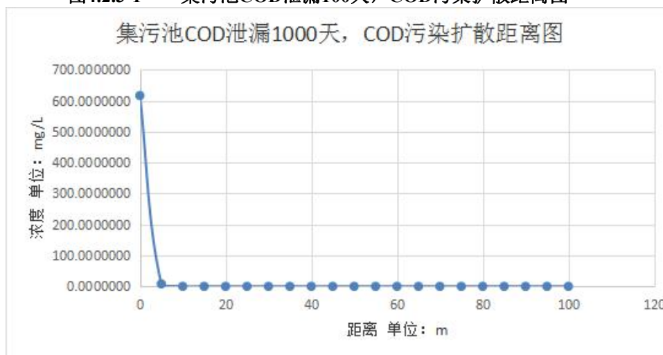
图4.2.3-2 集污池COD泄漏1000天，COD污染扩散距离图
