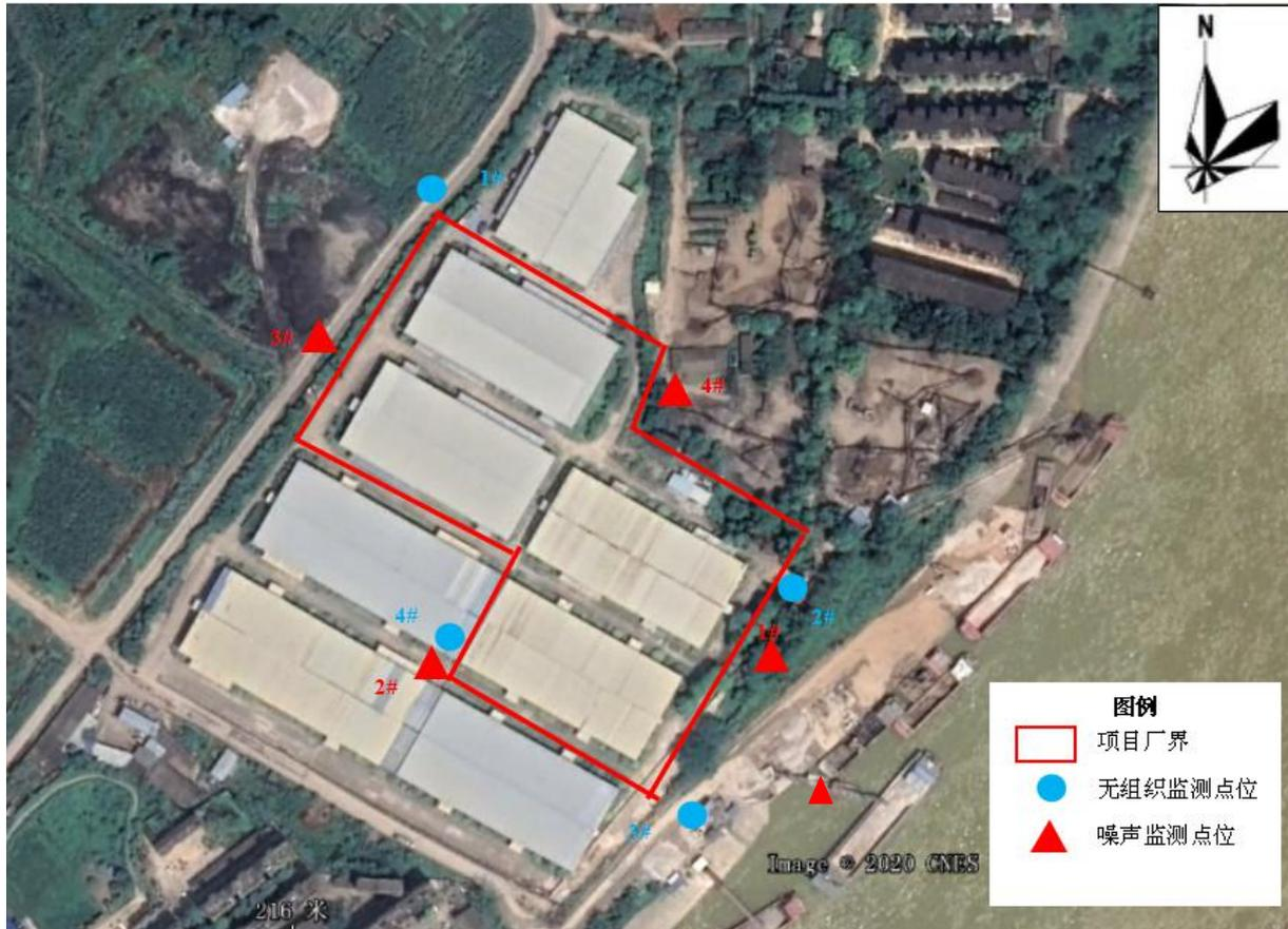
图 3-2 监测点位示意图（●表示废气监测点位，▲表示噪声监测点位）
