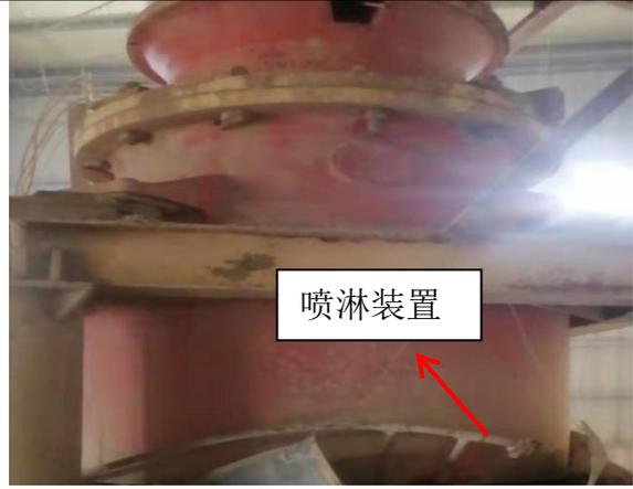
破碎机及喷淋装置
