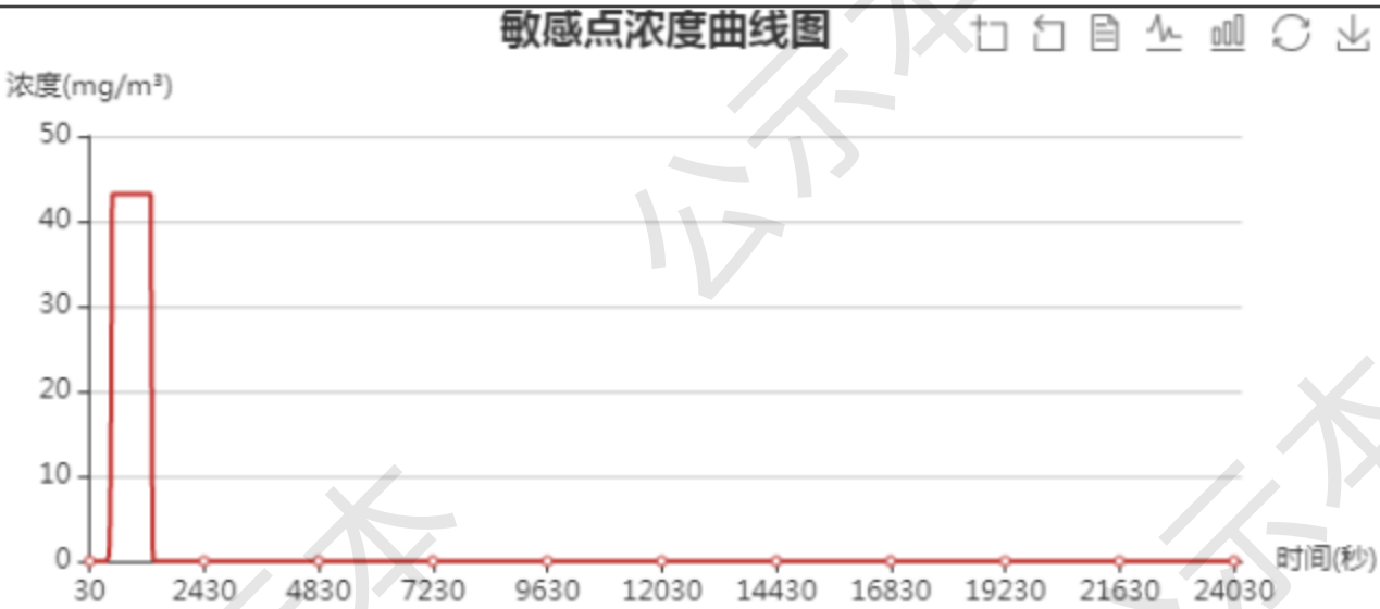
图 4.2.6-13 最不利气象条件下甲基叔丁基醚泄漏长滩屯散户浓度曲线图
