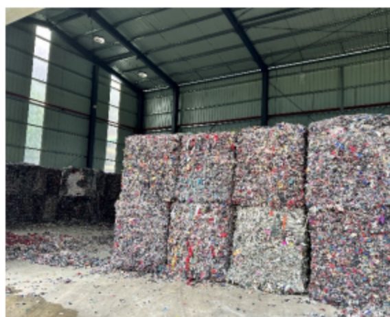
4、5线燃料替代仓库
