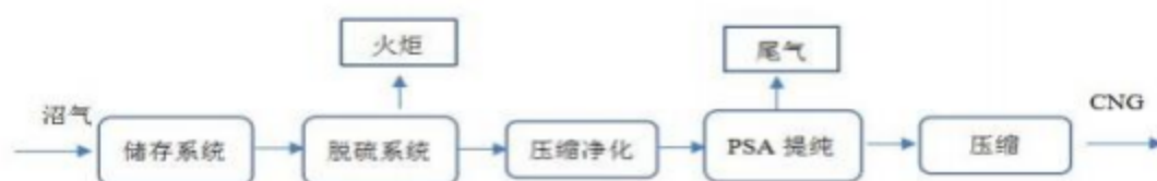
沼气净化提纯系统工艺流程图
