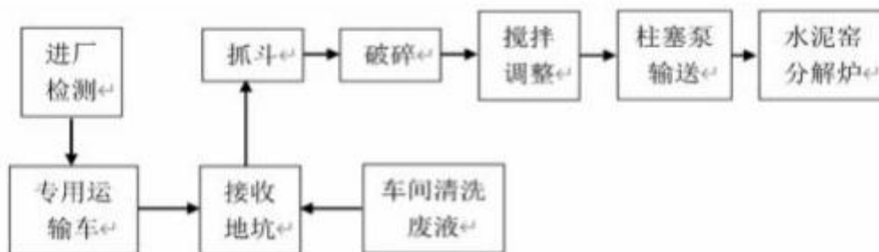
图 3.6-3 半固体废物预处理工艺流程图
