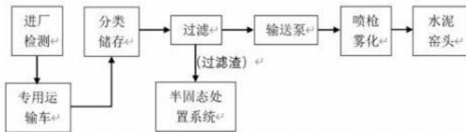
图 3.6-5 液态废物预处理工艺流程图
