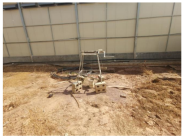
场区内地下水监控井
