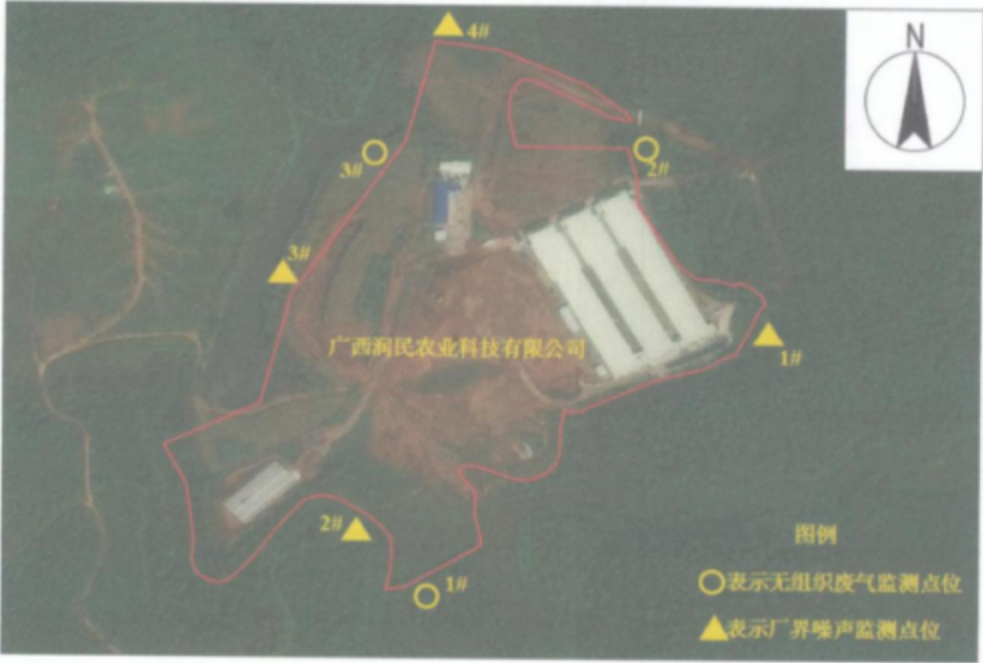
图 1 无组织废气及厂界噪声监测点位图
