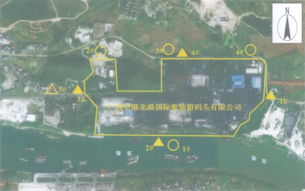
图 1 无组织废气及噪声监测点位图
