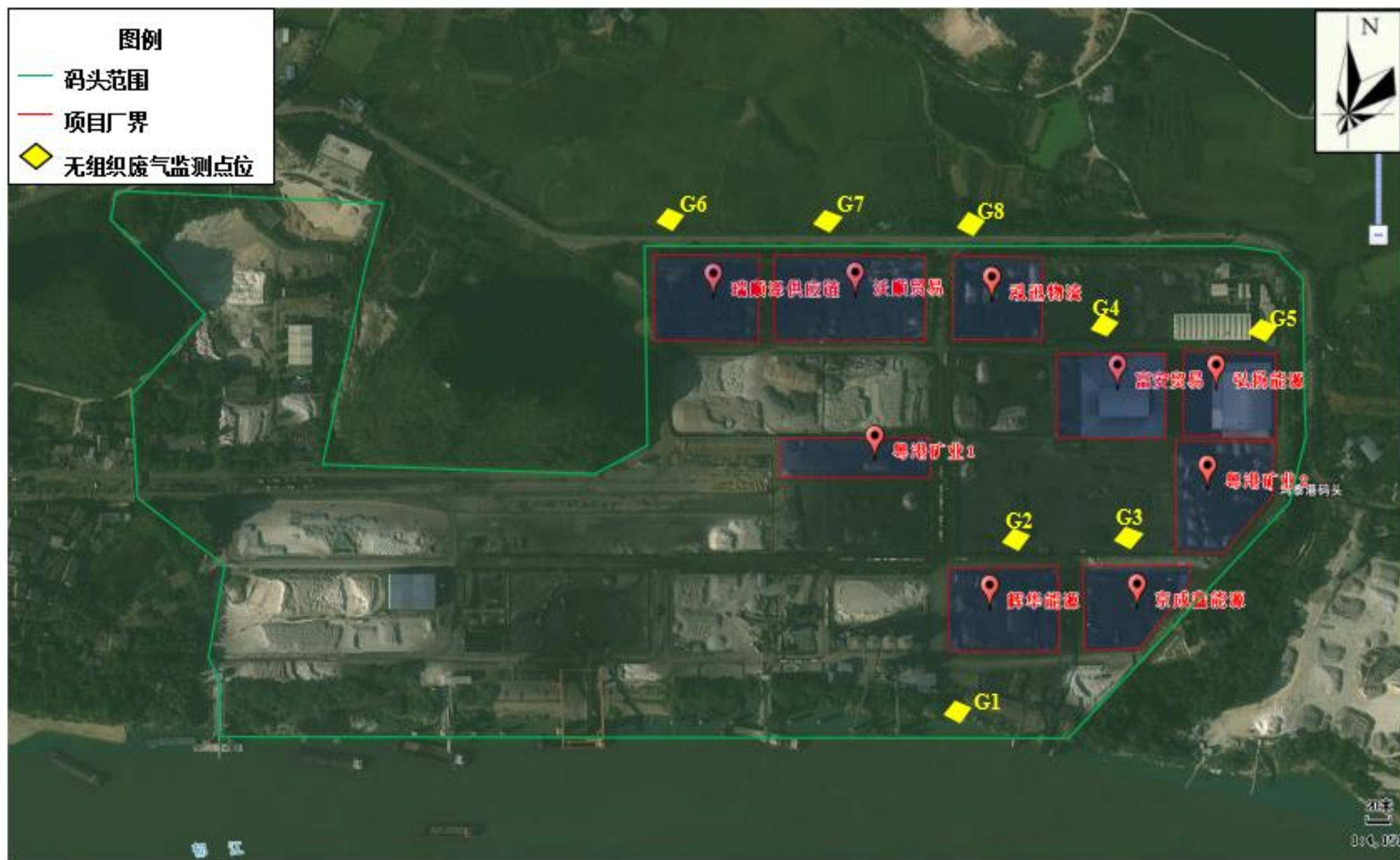
附图 3 项目无组织排放废气监测布点示意图（本项目厂界无组织废气监测点位为下图中的 G1 和 G2，验收期间主导风向为南风）
