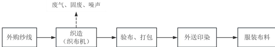
图 2-2 运营期针织布料织造工艺及产污流程图
